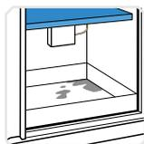
Gemäß **EN 14470-1**: Ein Bodenauffangbehälter muss immer unterhalb der unteren Lagerebene installiert werden. Der Bodenauffangbehälter muss ein Mindestfassungsvermögen von 10 % aller im Schrank gelagerten Behälter oder mindestens 110 % des Fassungsvermögens des größten Einzelbehälters haben, je nachdem, welcher Wert größer ist.
