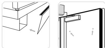
Sobald der Schrank ordnungsgemäß befestigt ist, sollte der Sockel an der Unterseite des Schrankes angebracht werden (siehe oben). Der Sockel wird im Inneren des Schrankes geliefert und verdeckt den Schranksockel. Sie gleitet an der Vorderseite entlang, bis sie mit den Schrankfüßen in Berührung kommt. Die Dichtung sollte sich auf der Oberseite befinden. Um die Sockelleiste zu entfernen, ziehen Sie einfach an beiden Seiten.
