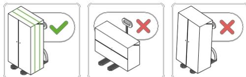
Der Sicherheitsschrank, den Sie soeben erhalten haben, wurde unter optimalen Bedingungen geschützt und transportiert, damit er während des Transports nicht beschädigt wird. Der Sicherheitsschrank darf nur von unten mit einem geeigneten Hilfsmittel (Saugnapf, Gurt, etc.) angehoben werden.
