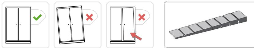
Der Schrank muss auf einer vollkommen ebenen Fläche aufgestellt werden, die das Gewicht des Schrankes bei voller Beladung tragen kann. Vergewissern Sie sich, dass der gesamte Schrank ordnungsgemäß verkeilt ist, um ein Umkippen zu verhindern, und dass das automatische TürschlieBsystem korrekt funktioniert (dieses System wird vor dem Versand überprüft). Eventuelle Nivellierungs- und Unterlegarbeiten müssen vom Benutzer durchgeführt werden.
