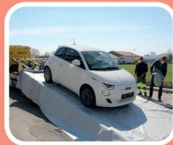
Das verunfallte Elektroauto wird vor dem Transport mit dem Car Service Set transportsicher verpackt: Unterteil des Decken-Sets ausbreiten und das Fahrzeug platzieren.
