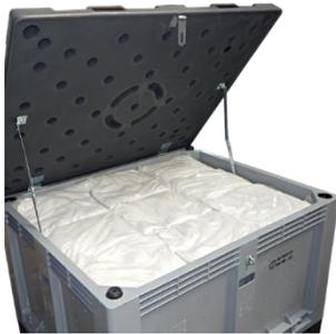
5. Bei Premium: Füllen Sie den Transportbehälter bis zur obersten Kante mit PE-Füllkissen auf.
