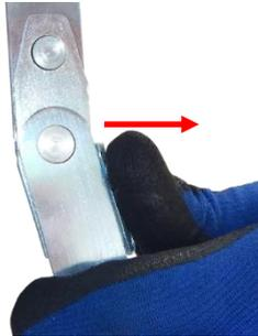
1. Halten Sie mit einer Hand den Deckel fest und lösen Sie die Arretierung an den Deckelhaltergelenken durch leichtes Ziehen in Richtung der Behältervorderseite.
