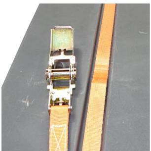
3. Führen Sie einen Spanngurt durch einen vorderen und hinteren Einfahrshuh unter dem Transportbehälter hindurch und legen Sie den Spanngurt in die vorgesehene Vertiefung im Deckel ein.
