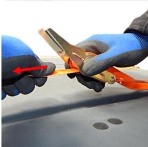
3. Ziehen Sie den Spanngurt aus der Drehwelle des Spannverschlusses heraus. Ziehen Sie anschließend den Spanngurt aus den Einfahrtschuhen heraus und lagern Sie den Spanngurt außerhalb des Arbeitsbereiches.
