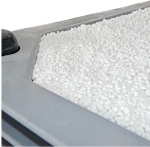
4. Bei Advanced: Bedecken Sie das eingebrachte Gefahrgut mit den im Lieferumfang befindlichen PyroBubbles® bis zur Behälteroberkante. Möchten Sie mehrere Lagen Gefahrgut in den Transportbehälter einbringen, so müssen Sie auf eine ausreichende Schichtdicke zwischen den einzelnen Lagen achten.
