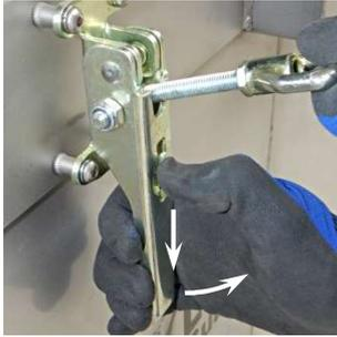
4. Drücken Sie den Sperrriegel des Spannverschlusses nach unten und bewegen Sie gleichzeitig den Verschlusshebel nach oben.
