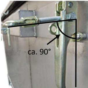
1. Legen Sie die Verschlussösen so um, dass diese einen rechten Winkel mit der Behälterwand einschließen.
