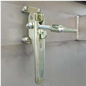
4. Drücken Sie den Verschlusshebel wieder nach unten bis der Sperrriegel selbsttätig einrastet.
