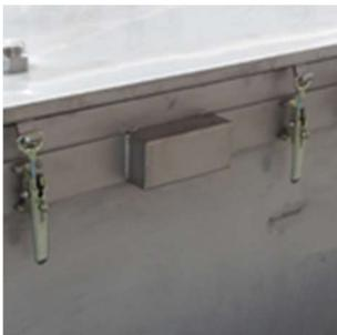
1. Der Transportbehälter ist im Auslieferungszustand durch die Spannverschlüsse verschlossen, der Innenbehälter mit Sterngriffschrauben.
