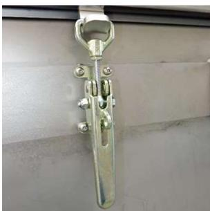
8. Drücken Sie die Verschlusshebel aller Spannverschlüsse nach unten bis der Sperrriegel selbsttätig einrastet.
