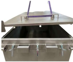
7. Heben Sie den Deckel mit einem geeigneten Hebezeug (Gabelstapler, Kran) ab.
