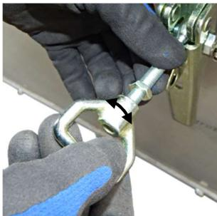
2. Verringern Sie den Spannweg durch Drehen der Verschlussöse entgegen dem Uhrzeigersinn. Verlängern Sie den Spannweg durch Drehen der Verschlussöse im Uhrzeigersinn.
