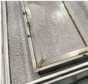
2. Die Zwischenräume zwischen Transportbehälter und Innenbehälter sind bis ca. zur Oberkante des Innenbehälters mit PyroBubbles® vorbefüllt.
