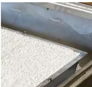
5. Füllen Sie den Innenbehälter bis zur obersten Kante mit PyroBubbles® auf. Die PyroBubbles®-Schüttung soll während der Befüllung durch mehrmaliges Klopfen (von innen) auf alle 4 Seitenwände des Innenbehälters mit einem Gummihammer verdichtet werden. Achten Sie besonders auf die korrekte, vollständige Befüllung!
