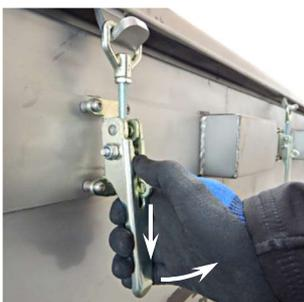
2. Drücken Sie den Sperrriegel des Spannverschlusses nach unten und bewegen Sie gleichzeitig den Verschlusshebel nach oben.
