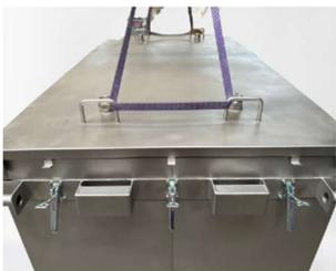
6. Befestigen Sie das Hebegeschirr an allen 4 Kranbügeln des Deckels.
