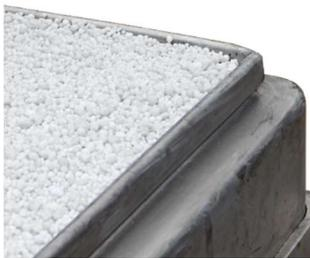
7. Füllen Sie den Transportbehälter bis zur obersten Kante mit PyroBubbles® auf. Die PyroBubbles®-Schüttung soll während der Befüllung durch mehrmaliges Klopfen auf alle 4 Seitenwände mit einem Gummihammer verdichtet werden. Achten Sie besonders auf die korrekte, vollständige Befüllung unter der oberen Kante und in den Ecken des Transportbehälters.
