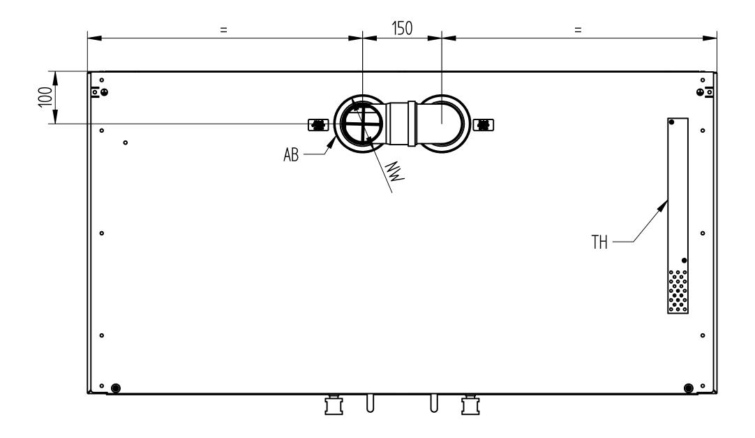
NW: 110, mit Adapter 75 AB: Abluftanschluss TH: Thermoelement
