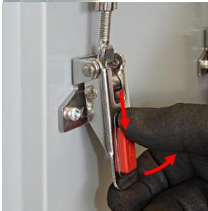
2. Drücken Sie den Sperrriegel eines Spannverschlusses nach unten und bewegen Sie gleichzeitig den Verschlusshebel nach oben.
