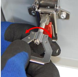
1. Verringern Sie den Spannweg durch Drehen der Verschlussöse entgegen dem Uhrzeigersinn. Verlängern Sie den Spannweg durch Drehen der Verschlussöse im Uhrzeigersinn.
