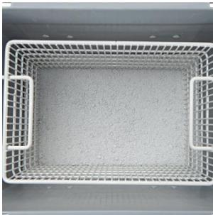
2. Bei Advanced: Geben Sie eine ebene und gleichmäßig verteilte Schicht PyroBubbles® mit einer Mindestfüllhöhe von 1 cm oberhalb des Gitterbodens ein.
