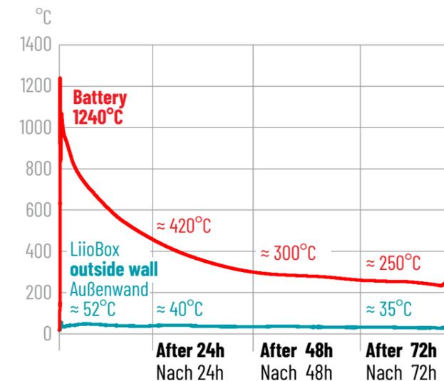
Wärmebildaufnahme 24 Stunden nach Zündung der Batterie. Die thermische Reaktion der entzündeten Batterie entwickelte Temperaturen in der Spitze von über 1200°C im Inneren der LioBox. Die gemittelte Aussentemperatur des Behälters beträgt während der gesamten Reaktionszeit kleiner 100°C.
